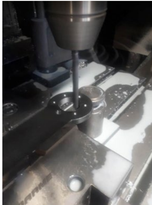
Fig. 29. Drilling \text{\O}7.5\text{mm} holes in the torsion arm
