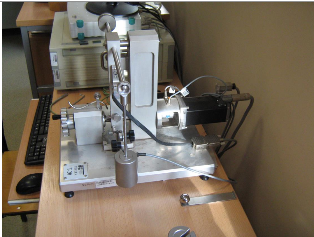
Rys. 4.12.5. Tribotester T-20 (widok od strony węzła obciążenia). Pracownia tribologii Wydziału Nauk Techniczny Uniwersytetu Warmińsko-Mazurskiego w Olsztynie (fot. J. Mikołajczyk).
