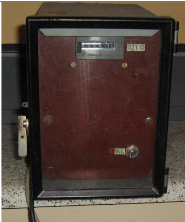
Rys. 4.22.5. Licznik obrotów próbki dolnej zastosowany w oryginalnym wyposażeniu tribotesteru SMC-2 (fot. J. Mikołajczyk).
