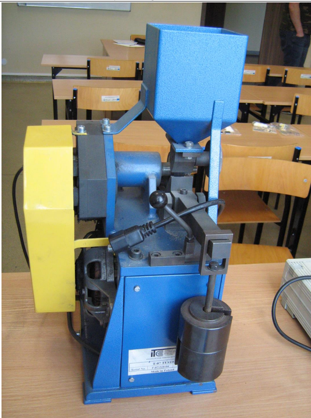
Rys. 4.11.6. Urządzenie do badania ścieralności T-07. Numer fabryczny T-07/118/04 z 2004 roku. Widok od strony zespołu obciążenia. Pracownia tribologii Wydziału Nauk Technicznych Uniwersytetu Warmińsko-Mazurskiego w Olsztynie (fot. J. Mikołajczyk).
