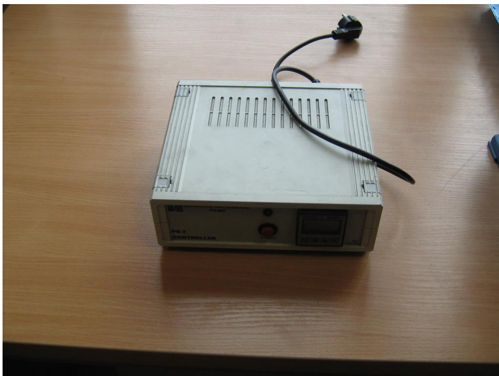
Rys. 4.11.13. Sterownik PS-2 Controller zastosowany do programowania parametrów pracy urządzenia do badania ścieralności T-07. Pracownia tribologii Wydziału Nauk Techniczny Uniwersytetu Warmińsko-Mazurskiego w Olsztynie (fot. J. Mikołajczyk).
