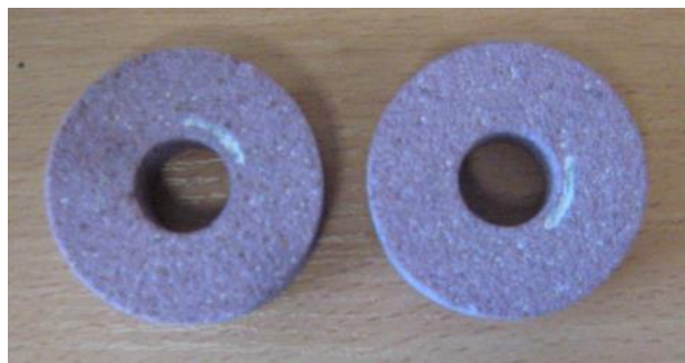
Rys. 4.22.11. Przykładowe próbki typu tarcza-tarcza wykonane z materiału ściernego złączone spoiwem, przeznaczone do badań na tribotesterze SMC-2 (fot. J. Mikołajczyk)
