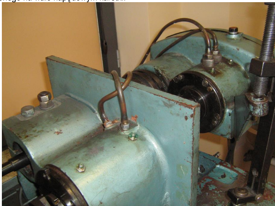
Rys. 4.22.8. Przewody systemu chłodzenia wału napędu karetki oraz wrzeciennika dolnej próbki
