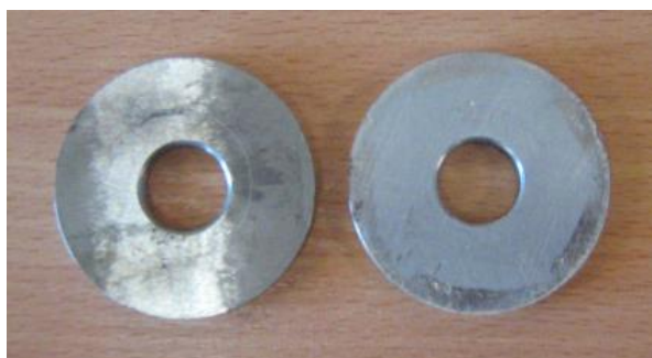
Rys. 4.22.10. Przykładowe próbki typu tarcza-tarcza wykonane ze stali, przeznaczone do badań tribologicznych na urządzeniu SMC-2 (fot. J. Mikołajczyk)
