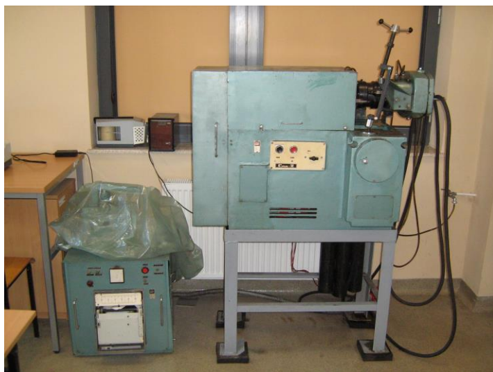
Rys. 4.22.1. Widok ogólny urządzenia SMC-2 (po lewej stronie widoczny jest pulpit sterujący z drukarką momentu tarcia). Fot. J. Mikołajczyk
