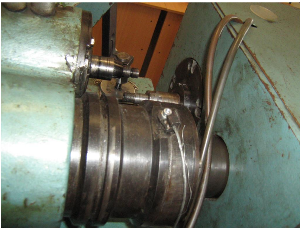
Rys. 4.22.6. Na pierwszym planie wał napędu karetki. W głębi po prawej stronie wał napędu dolnej próbki, po lewej - wał próbki górnej. Fot. J. Mikołajczyk
