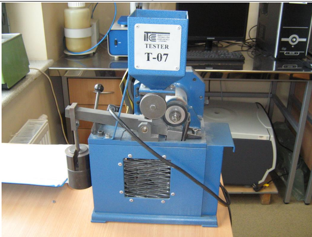
Rys. 4.11.4. Urządzenie do badania ścieralności T-07. Widok od strony węzła tarcia. Pracownia tribologii Wydziału Nauk Technicznych Uniwersytetu Warmińsko-Mazurskiego w Olsztynie. (fot. J. Mikołajczyk)
