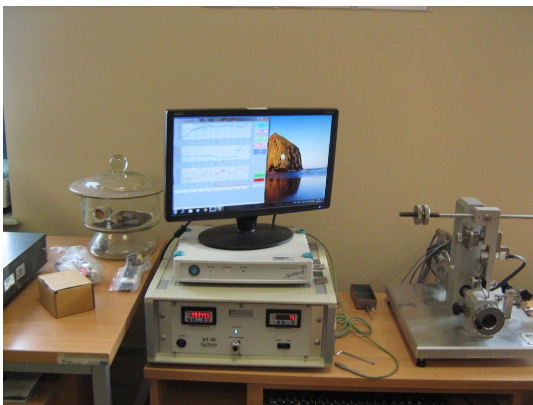
Rys. 4.12.4. Stanowisko badawcze typu kula-tarcza zbudowane z zestawu urządzeń: sterownika BT-20, wzmacniacza Spider 8 oraz tribotestera T-20. Pracownia tribologii Wydziału Nauk Techniczny Uniwersytetu Warmińsko-Mazurskiego w Olsztynie (fot. J. Mikołajczyk).
