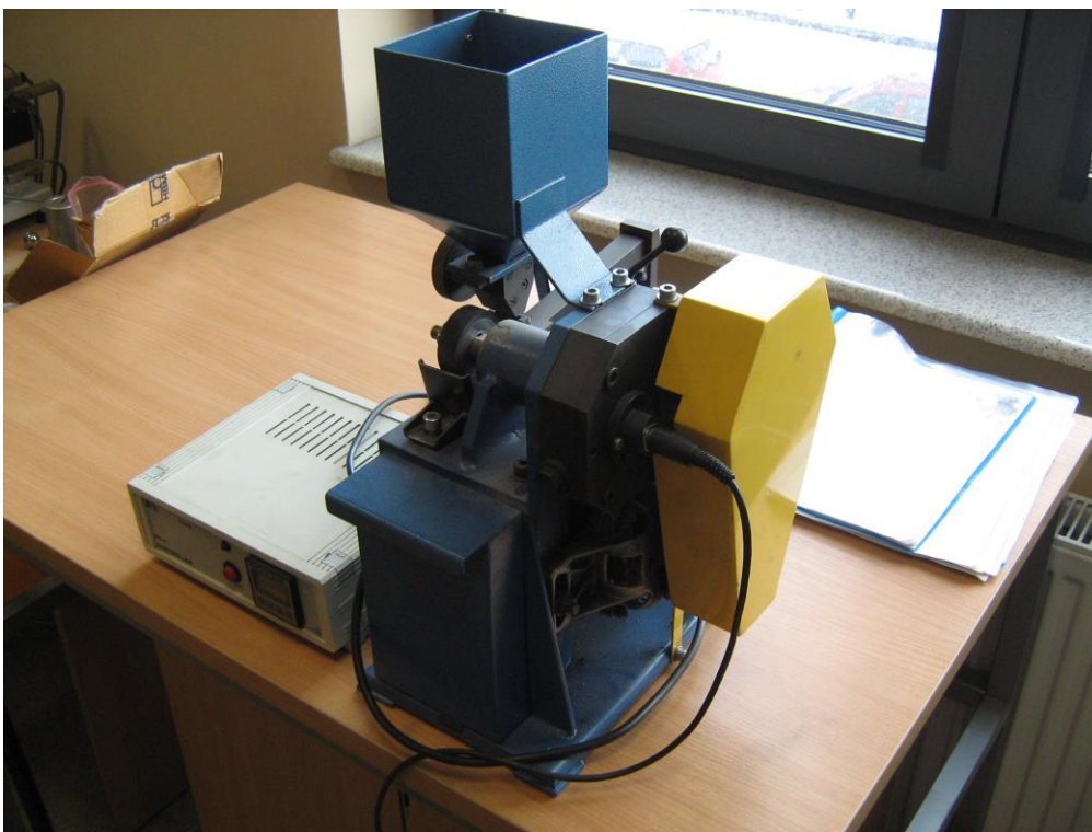
Rys. 4.11.5. Urządzenie do badania ścieralności T-07. Numer fabryczny T-07/118/04 z 2004 roku. Widok od strony napędu. Pracownia tribologii Wydziału Nauk Technicznych Uniwersytetu Warmińsko-Mazurskiego w Olsztynie. (fot. J. Mikołajczyk)
