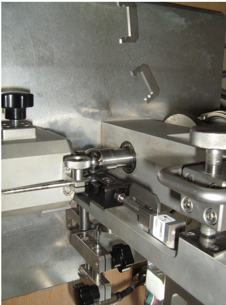
Rys. 4.12.6. Węzeł tarcia typu kula-tarcza zastosowany w triboterze T-20. Pracownia tribologii Wydziału Nauk Techniczny Uniwersytetu Warmińsko-Mazurskiego w Olsztynie (fot. J. Mikołajczyk).
