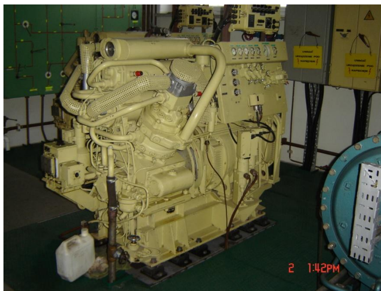
Ryc. 12. Sprężarka do wytwarzania nadciśnienie pochodzenia radzieckiego (Materiał własny).
